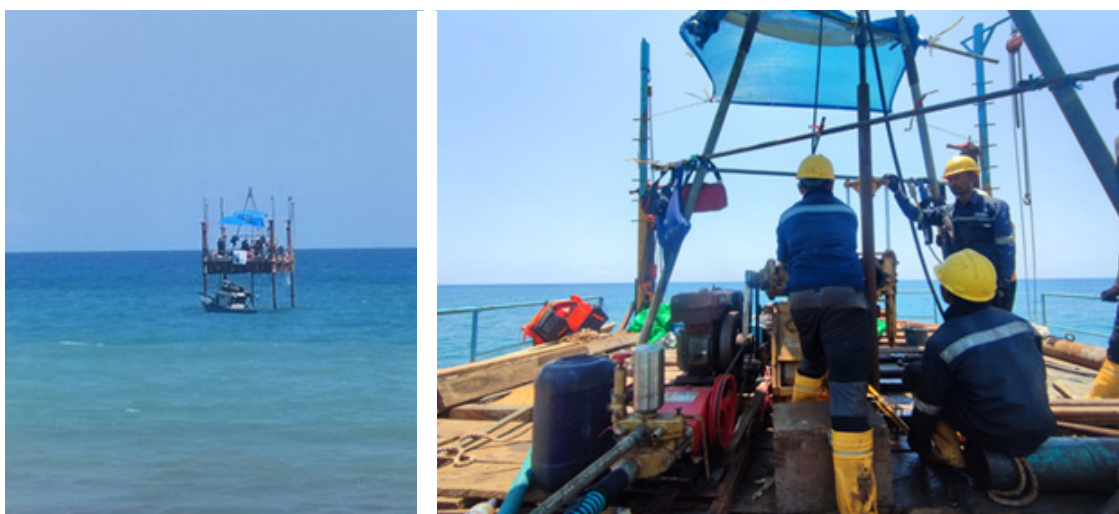
Figura 4.7: Campanha de levantamento para recolha de dados geotécnicos na area offshore da Base Logística do Suai( SSB).
