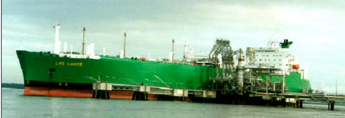
Figure 16. LNG Lagos - Membrane Type LNG Carrier
